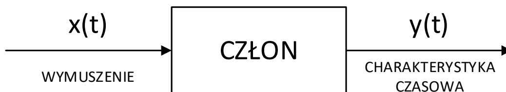
Rys. 1. Schemat blokowy układu dynamicznego, gdzie x(t) oznacza sygnał wejściowy (wymuszenie), y(t) sygnał wyjściowy (odpowiedź układu), a blok „człon” reprezentuje analizowany element lub proces.
